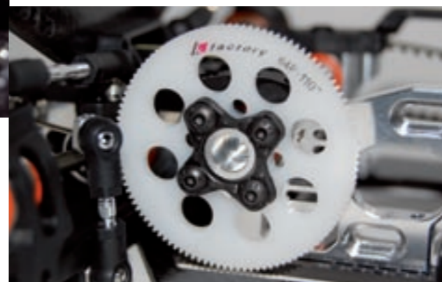
Das Hauptzahnrad weist in der Standard-Auslieferung 110 Zähne auf. Je nach Anforderung kann es schnell und leicht gewechselt werden
