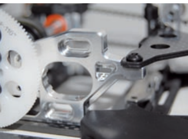
Ein gefräster Aluminium-Träger nimmt den Motor auf
