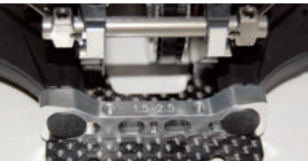
Tragende Teile verfügen über ein Buchsen-System, mit dem die gewünschte Geometrie exakt festgelegt werden kann
